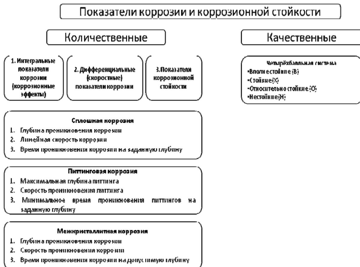
Рис. 3.12 – Классификация показателей коррозионной стойкости
