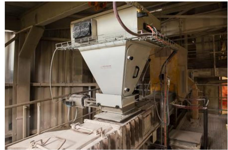
**Анализатор химического состава в аэрожелобе (трубного типа)**
