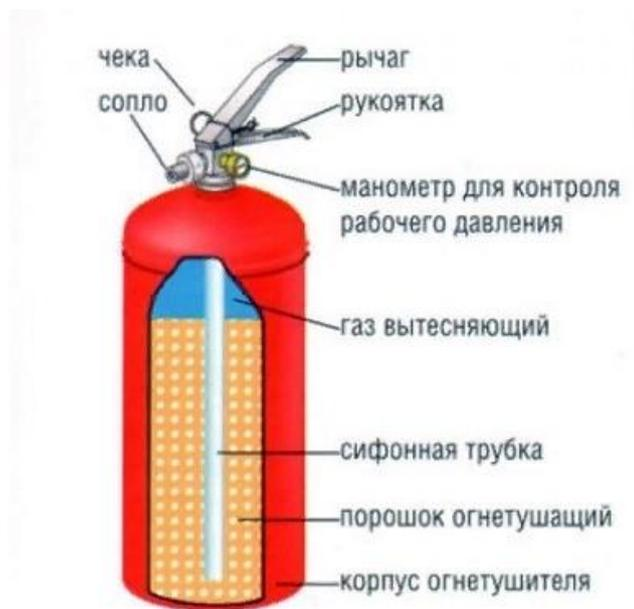
Рис. 5.2. Устройство порошкового огнетушителя
