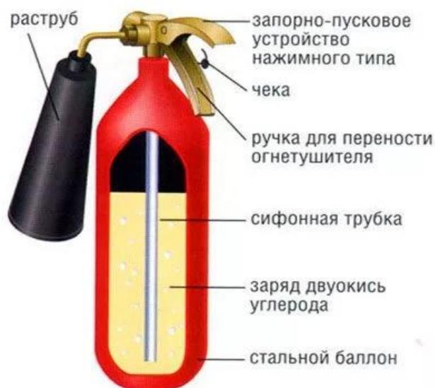
Рис. 5.3. Схема устройства углекислотного огнетушителя
