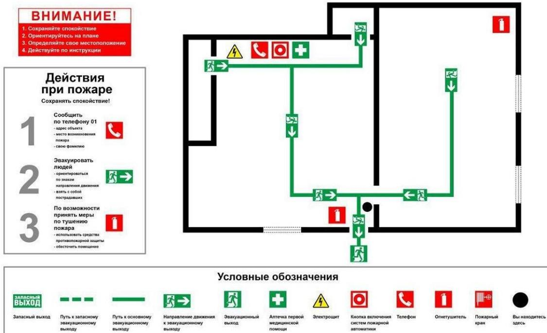
Рис. 5.1. Примерный вид плана эвакуации
