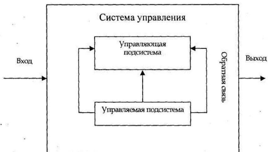
Рис.2. Связи управляющей и управляемой систем
