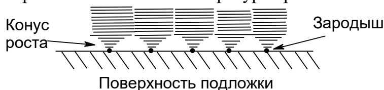
Рис. 1-19. Образование пленки пироуглерода на поверхности подложки
