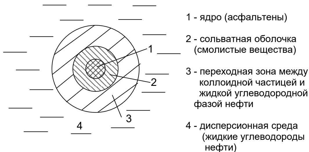
Рис. 1-46. Структура смолисто-асфальтеновой частицы
