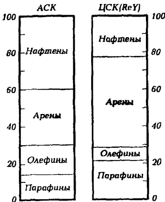
Рис. 8.3. Сравнение распределения химических компонентов в продуктах крекинга газойля на алюмосиликатном и цеолитном катализаторах
