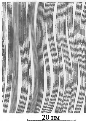
Рис. 2.1. Схематическое изображение ленточной структуры углеродного волокна
