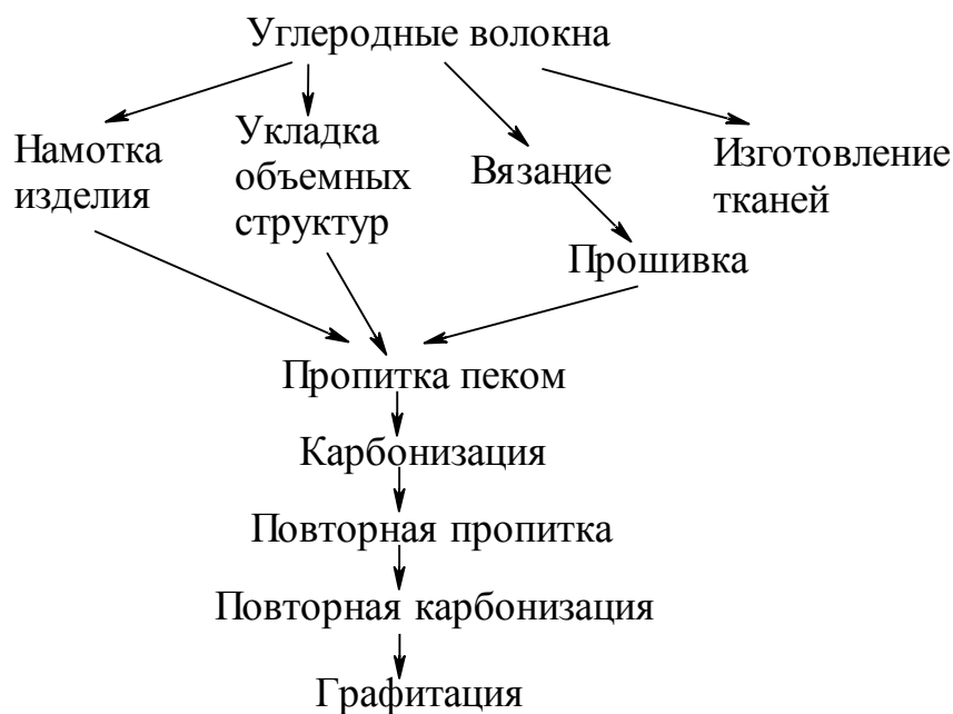
Рис. 7.10. Схема получения УУКМ с использованием метода пропитки
