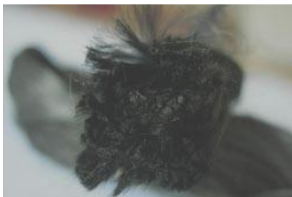
Рис. 8.7. Общий вид углеродного жгута из вискозного волокна. 100 000 филаментов
