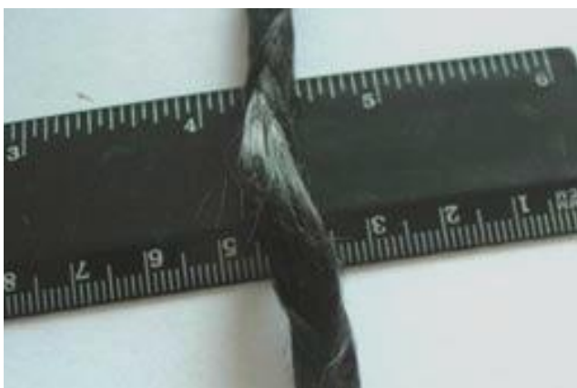
Рис. 8.7. Общий вид углеродного жгута из вискозного волокна. 100 000 филаментов
