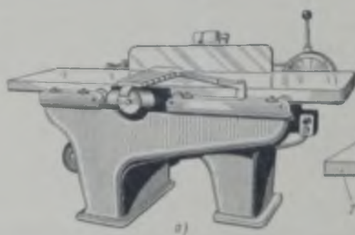
Рис. 10. Фуговальный станок (а), модель СФ-6 и схема основного узла (б):
