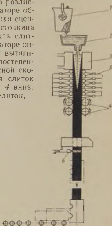
Рис. 255. Схема установки для непрерывной разливки стали
