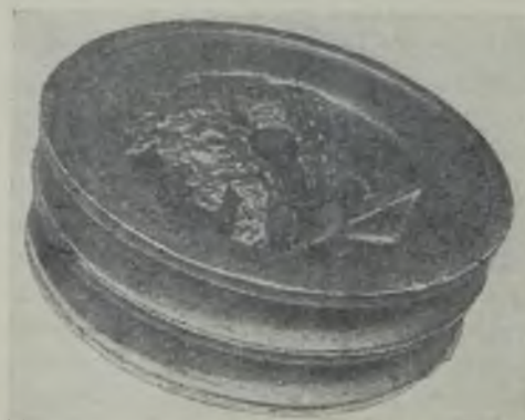
Рис. 267. Брак отливок из-за обвала формы
