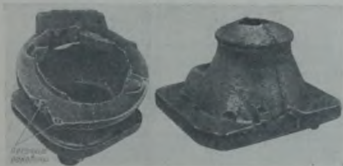
Рис. 268. Песочные раковины в отливке
