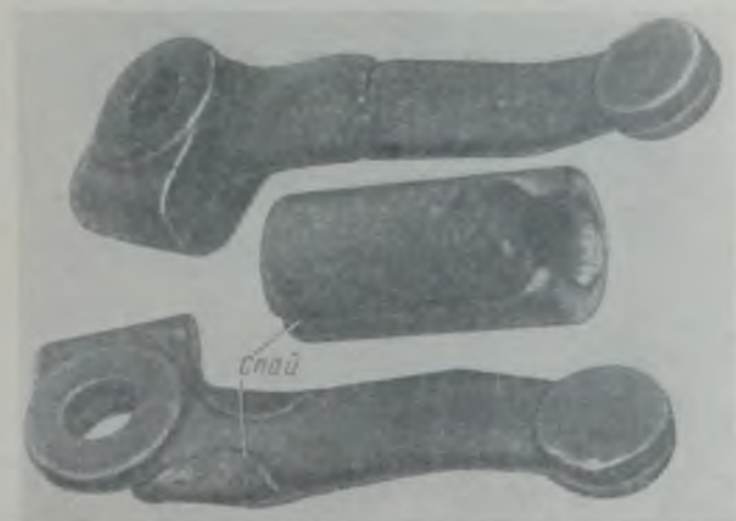
Рис. 261. Спай в отливке
