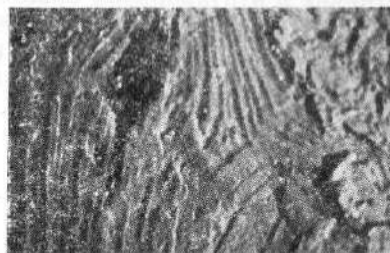
Рис. 2-9. Электронная микрофотография нефтяного кокса слоистой структуры. Реплика с травленного шлифа, \times 10\,000 .
