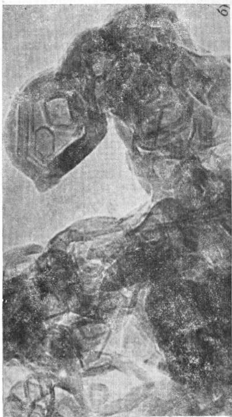
Рис. 14-5. Электронные микрофотографии стеклоглуглерода (а), полученного при 3000°C ( \times 150\ 000 ) и графитированной газоканальной сажи (б) ( \times 900\ 000 ). Травленный скол; частички, вырванные в реплику.
