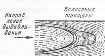
Рис. 12-9. Модель ориентации частичек в продольном разрезе выдавленного прутка [12-19].
