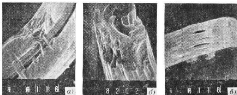
Рис. 9-20. Дефекты в углеродных волокнах из ПАН-волокна. Сканирующий электронный микроскоп, \times 12\,000 [9-27].
