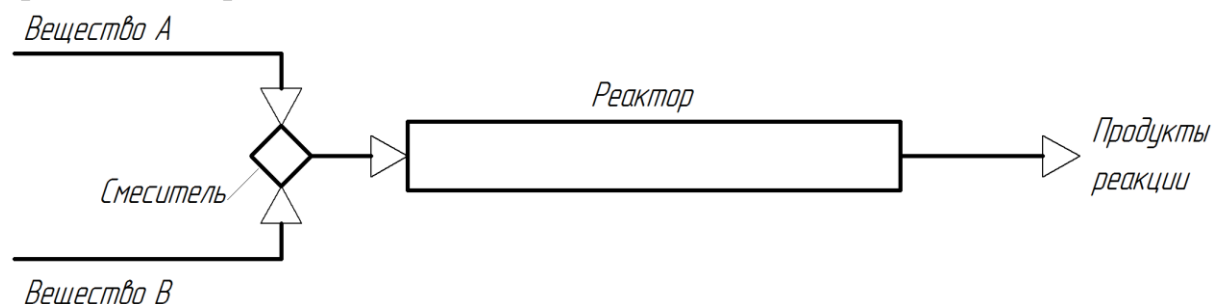
Рис.64. Аппаратурное оформление реакторного узла для осуществления газофазных реакций.
